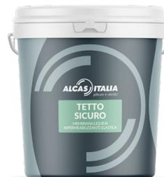
Membrana liquida a base di resine elastomeriche che, congiuntamente alle speciali cariche impiegate nella formulazione, conferiscono notevole resistenza all'usura e al calpestio, buona elasticità, notevole adesione al supporto, ottima resistenza agli agenti atmosferici, facilità di applicazione.
